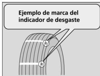
La ranura en la que está situado el indicador de desgaste es 1/16 inch (aproximadamente 1,6 mm) más profunda que cualquier otro punto del neumático. Si la banda está desgastada y el indicador queda visible, sustituya el neumático. **Los neumáticos desgastados presentan una tracción deficiente en calzadas mojadas.**
