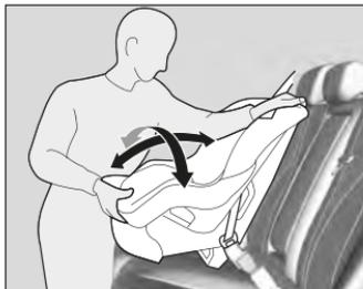
**5.** Coja la parte del hombro del cinturón de seguridad cerca de la hebilla y tire hacia arriba para eliminar cualquier holgura de la parte de la cadera del cinturón.
