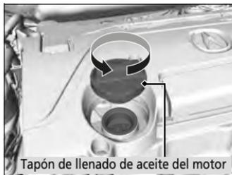
1. Desensrosque y retire el tapón de llenado de aceite del motor.
