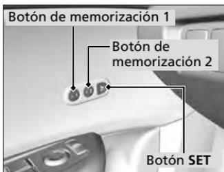
1. Fije el modo de alimentación en CONTACTO. Ajuste el asiento del conductor a la posición deseada.
