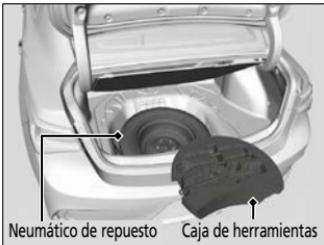
2. Saque la caja de herramientas del maletero. Saque el gato y la llave para las tuercas de rueda de la caja de herramientas.
