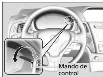
Cuando el modo de alimentación está en CONTACTO, puede usar el mando de control de brillo para ajustar el brillo del tablero de instrumentos.
