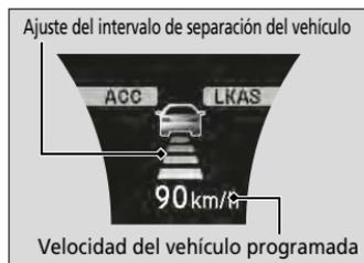
Ajuste del intervalo de separación del vehículo
