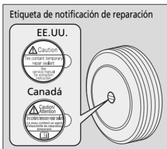
12. Coloque la etiqueta de notificación de reparación en la superficie plana de la rueda.
