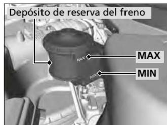
El nivel del líquido debe estar entre las marcas **MIN** y **MAX** en el lateral del depósito.
