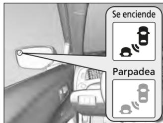
Indicador de alerta del sistema de información de punto ciego: Situado en los retrovisores exterior de ambos lados.
