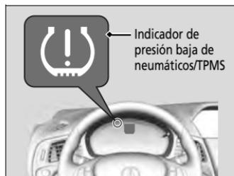
Controla la presión de los neumáticos mientras conduce. Si la presión de los neumáticos del vehículo se reduce significativamente, el indicador de presión baja de neumáticos/TPMS se enciende y aparece un mensaje en la pantalla multi-información.
