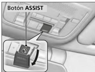
Si necesita hablar con el operador de AcuraLink en caso de emergencia, puede conectarse manualmente pulsando el botón **ASSIST** con el modo de alimentación en ACCESORIOS o CONTACTO.
