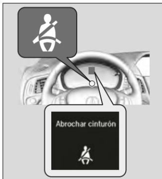
El sistema del cinturón de seguridad incluye un indicador en el panel de instrumentos para recordar al conductor, al acompañante o a ambos que deben abrocharse los cinturones. Si el interruptor de encendido se gira a CONTACTO y algún cinturón de seguridad no está abrochado, sonará un aviso acústico y parpadeará el indicador. Pasados unos segundos, el avisador acústico se detendrá y el indicador se encenderá y permanecerá iluminado hasta que se abroche el cinturón de seguridad.
