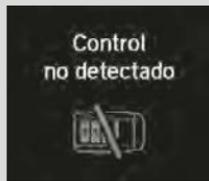
Cuando el modo de alimentación está en cualquier modo que no sea APAGADO y retira el mando a distancia de acceso sin llave del vehículo y cierra la puerta, suena una alarma. Si sigue sonando la alarma, coloque el mando a distancia sin llave en otro sitio.
