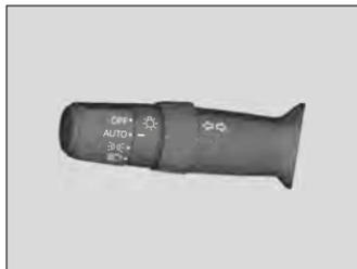
El control de luces automáticas se puede utilizar cuando el modo de alimentación está en CONTACTO.
