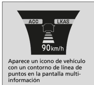
El vehículo mantiene la velocidad programada sin que haga falta tener pisado el pedal del freno o del acelerador.
