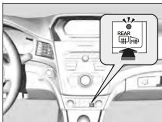
Pulse el botón del desempañador trasero y los retrovisores térmicos para desempañar la luneta y los retrovisores con el modo de alimentación en la posición de CONTACTO.
