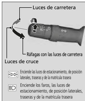
Al girar el interruptor de luces se encienden y apagan las luces, con independencia del ajuste del modo de alimentación.
