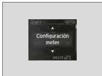
2. Pulse y suelte el botón ▲ⓘ/▼ hasta que aparezca **Configuración meter** en la pantalla.
