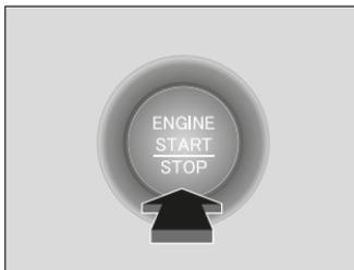
3. Pulse el botón **ENGINE START/STOP** sin pisar el pedal del acelerador.
