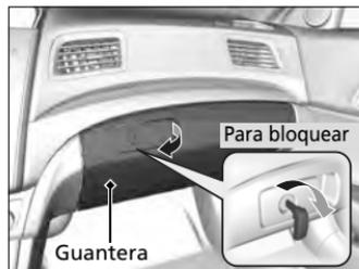
Tire de la manecilla para abrir la guantera. La guantera se puede bloquear con la llave integrada.
